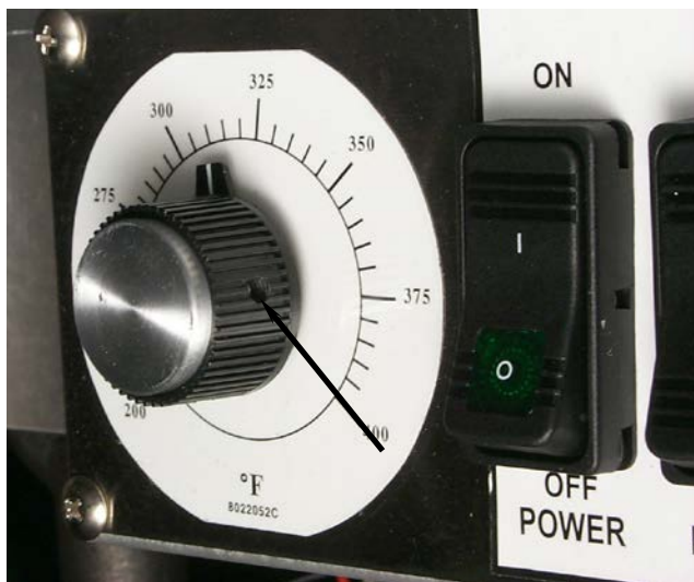
Emplacement de vis de retenue de la poignée de contrôle (flèche - réglage dans le bouton).
