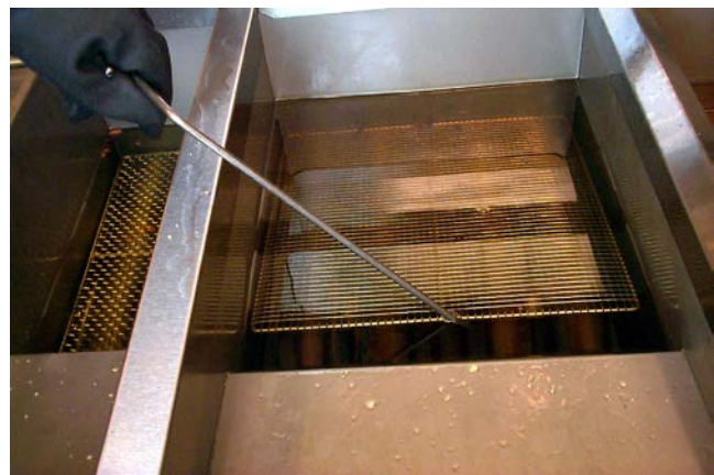
Retrait de la grille du support de la cuvette avant le filtrage.
