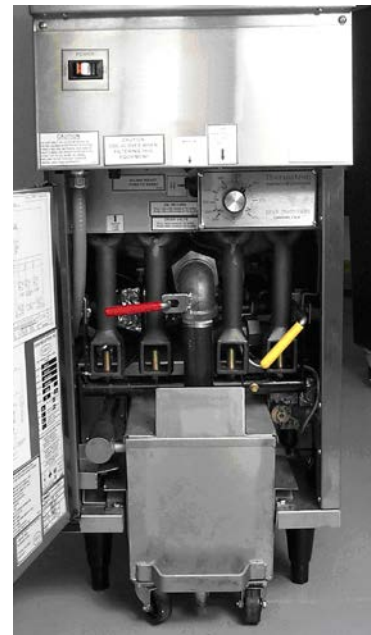
Filtre unique typique sous friteuse (SUFF) installé dans une seule friteuse.
