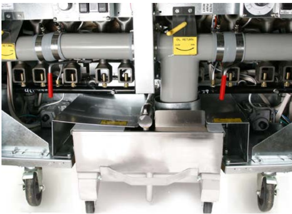
Filtre typique sous friteuse (UFF) installé dans un système de cuisson multi-batteries.
