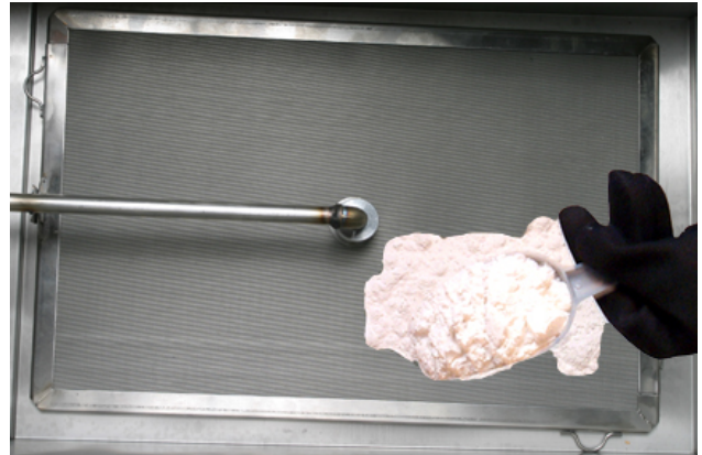
Application de poudre de filtre au cadre filtrant.
