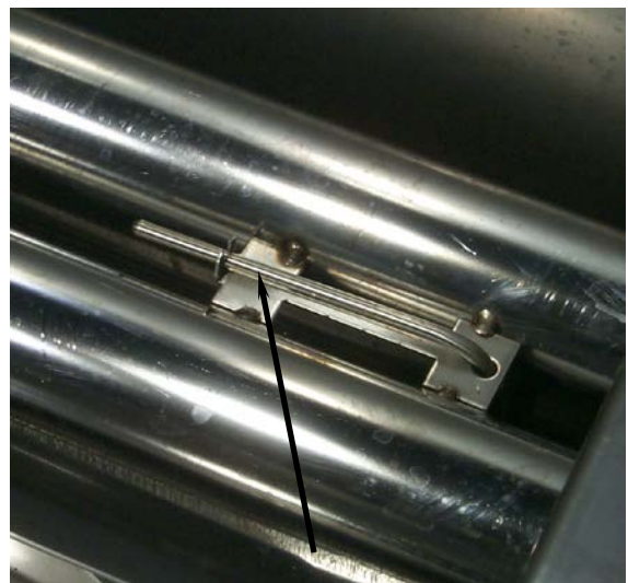
Sonde du thermostat électronique dans la cuve (flèche).
