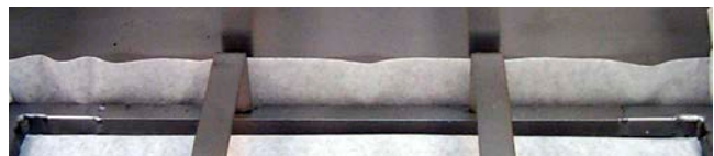
S'assurer que le papier filtre chevauche deux pouces de tous les côtés et est distribuée uniformément sous la bague de retenue.
